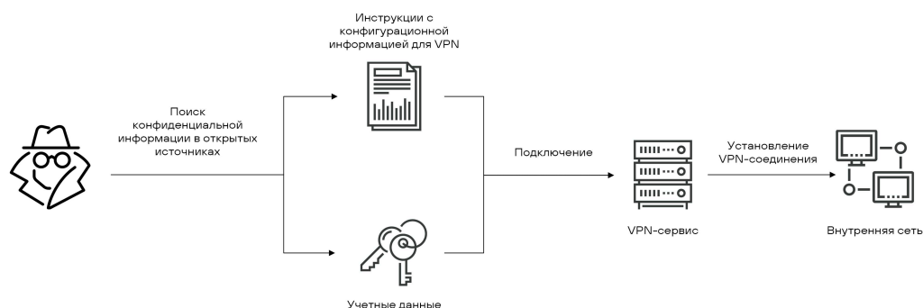
Рисунок 49. Возможный вектор проникновения в корпоративную инфраструктуру с использованием полученных в результате OSINT данных при отсутствии MFA
