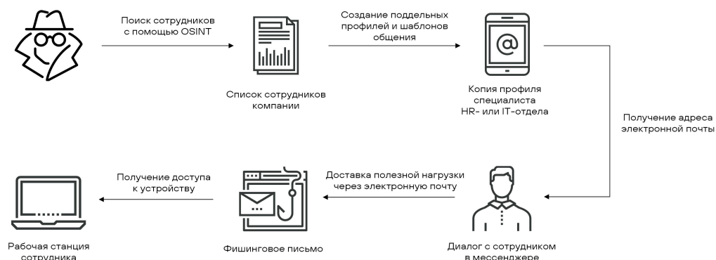
Рисунок 61. Возможный вектор проникновения в корпоративную инфраструктуру с помощью фишинговой атаки
